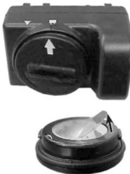
Zum Entfernen der Batterie eine Münze in den Schlitz auf der Oberseite des Batteriemoduls stecken, leicht nach unten drücken und gegen den Uhrzeigersinn drehen. Drehen Sie die Batterie mit den Kontakten nach oben. Die Schutzfolie entfernen Sie durch Anheben der roten Lasche und Abziehen der Folie.
