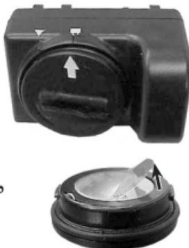
Para retirar a bateria, insira uma moeda na ranhura na face superior do módulo da bateria, pressione ligeiramente e, de seguida, rode no sentido inverso aos ponteiros do relógio. Encaixe a bateria na face de contacto. Para remover a película de protecção, levante a tarjeta vermelha e puxe a película.
