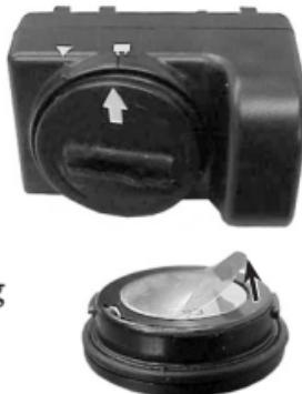
Om de batterij te verwijderen, stopt u een muntstukje in de gleuf boven op de batterijmodule, duwt u zachtjes naar beneden en draait u in tegenwijzerzin. Draai de batterij naar de contactzijde. Om de beschermende film te verwijderen, heft u het rode lipje op en trekt u de film eraf.
