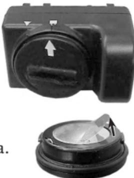
Para sacar la pila, introduzca una moneda en la ranura en la parte superior del módulo de la pila, empuje ligeramente en sentido contrario a las agujas del reloj. Empuje la pila hacia el lado de contacto. Para quitar la película protectora, levante la etiqueta roja y tire de la película.
