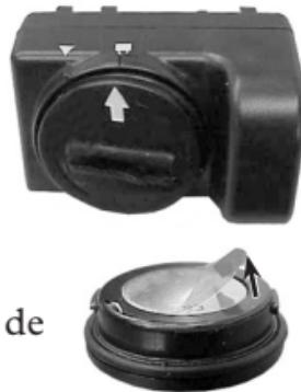
Pour retirer la pile, insérez une pièce de monnaie dans la fente située en haut de l'emplacement de la pile, poussez légèrement vers le bas et tournez dans le sens inverse des aiguilles d'une montre. Tournez la pile de façon à faire apparaître la surface de contact. Pour retirer le film de protection, enlevez la languette rouge et détachez le film.
