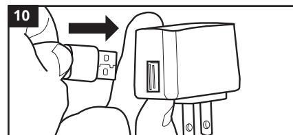
**DE** Verbinden Sie das Netzkabel mit dem USB-Adapter und verbinden Sie das Gerät mit dem Stromnetz. Binden Sie überschüssiges Kabel mit einem Kabelbinder sicher zusammen und platzieren Sie es hinter dem Trinkbrunnen, um zu verhindern, dass Ihr Heimtier daran kaut oder sich darin verfangt. **EN** Attach
