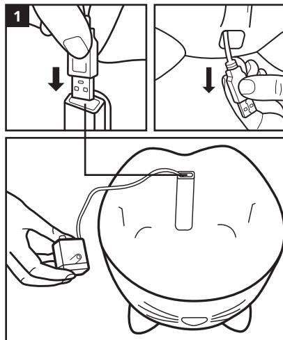
i kabelrenden i vandreservoiret, og træk kablet igennem. Anbring pumpen i siden. **RU** Извлеките устройство из упаковки. Снимите крышку фонтанчика и поддон фильтра. Вставьте USB-кабель в кабельный желоб в резервуаре с водой и протяните через него кабель. Расположите насос сбоку.
