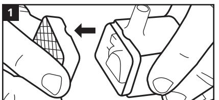
prima di riassemblarle con cautela. **DK** Skål delene med vand og fjern eventuelle hår eller smuds fra rotoren og pumpehuset før den forsigtigt samles igen. **RU** Промойте каждый компонент водой, удалив щерсть и мусор с рабочего колеса и корпуса насоса, прежде чем выполнить повторную сборку с максимальной осторожностью и внимательностью.
